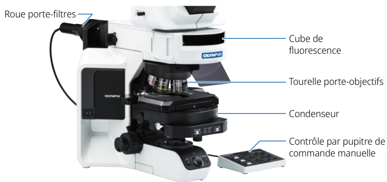
Système semi-motorisé Mise à niveau des composants clés vers leurs versions motorisées
