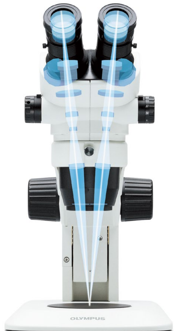
El sistema óptico Greenough tiene dos trayectorias ópticas de aumento inclinadas en un ángulo de 10°. Esto hace posible un diseño de microscopio compacto con un alto rendimiento.
