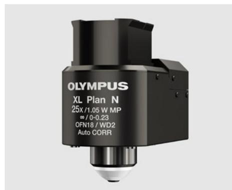
FV30-AC25W (25X Objektiv zur Immersion in Wasser; NA: 1,05; A.A.: 2 mm)
