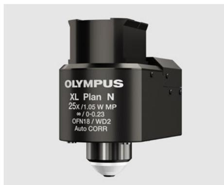
FV30-AC25W (objectif 25X à immersion dans l'eau ; ON : 1,05; DF : 2 mm)
