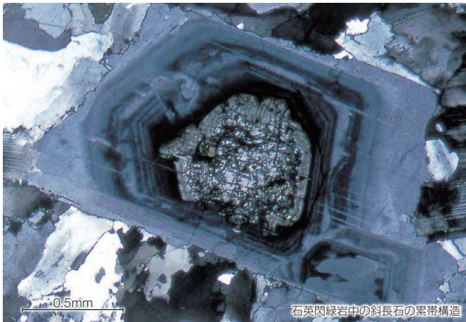
石英閃緑岩中の斜長石の累帯構造
