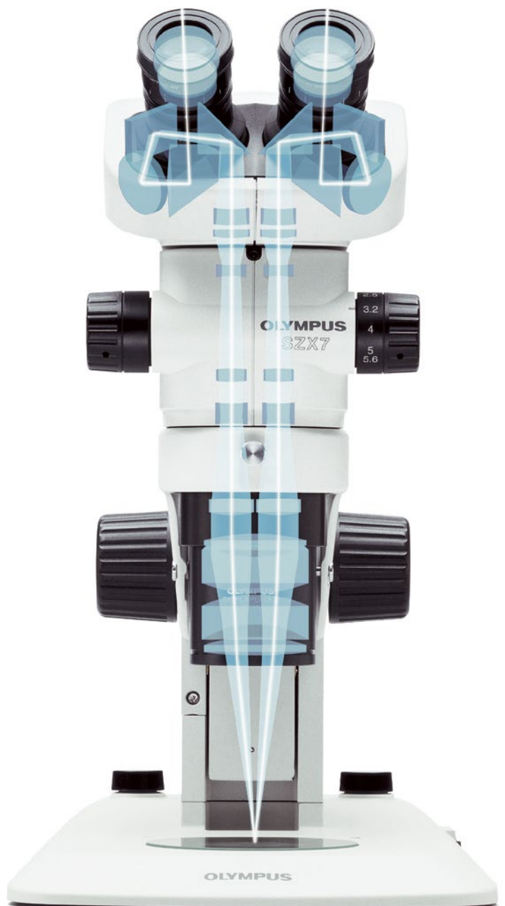
伽利略光学器件具有两条（右 / 左）独立的平行变倍光学路径。该系统能够实现高光学性能以及系统模块化。
