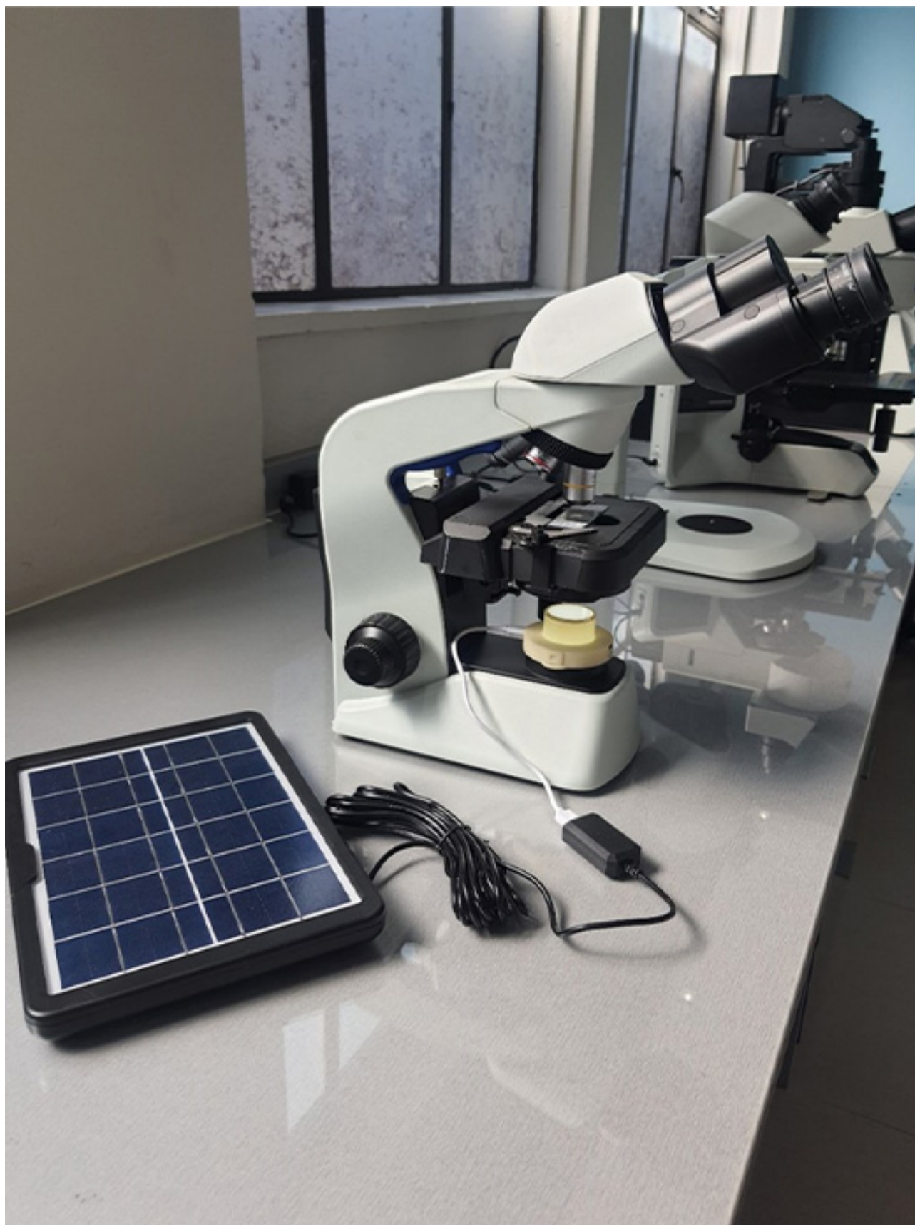
图3.安装在CX23显微镜上并与太阳能电池板电源连接的USB LED灯的图像。
