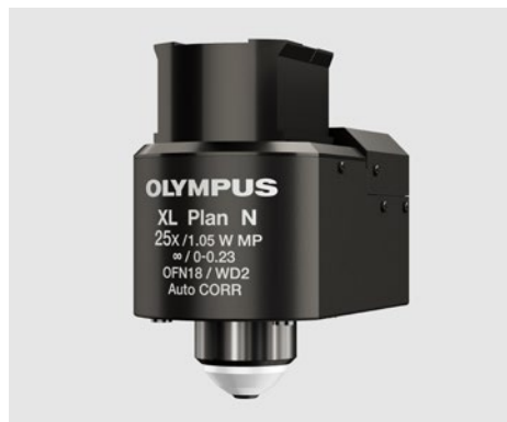
FV30-AC25W(25X 침수형 대물렌즈, NA: 1.05, W.D.: 2mm)
